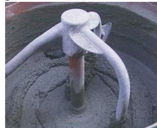
サンユモルタル1袋20kgに清水を加え、モルタルミキサーで3分以上混練します。
